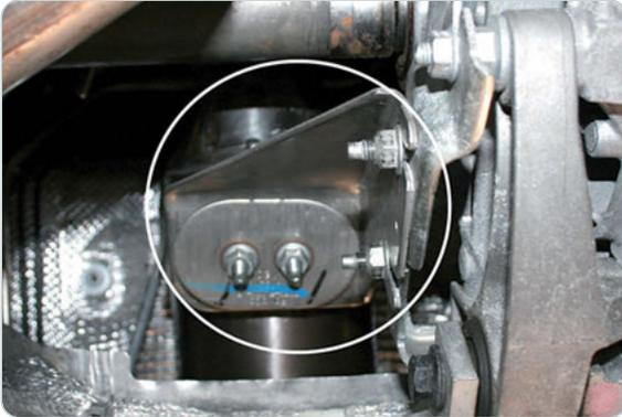
Wir empfehlen, die Schelle und die Dichtung zwischen dem Tuningkatalysator und dem Turbolader/Motor sowie der Abgasanlage zu erneuern.
